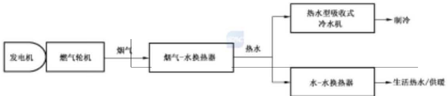
图 B.3 配置 3 烟气-水换热器形式的直接利用余热系统
