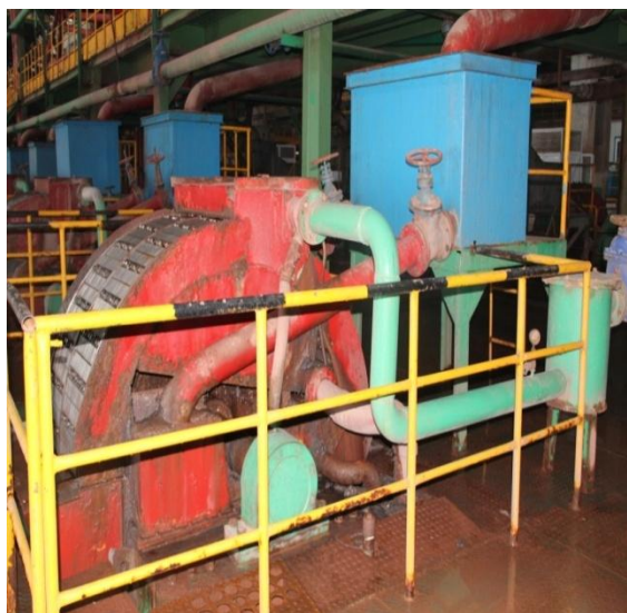
MVS2420高频振动细筛 筛孔尺寸: 015 \times 0.3\text{mm} 安装倾角: 25 \pm 2^\circ 振动频率: 50Hz
