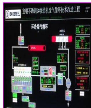
不锈钢132m 2 烧结机废气循环中试装置（2012.10投运）
