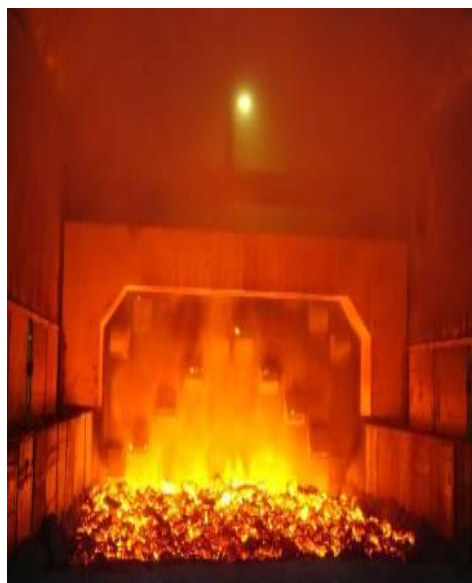
钢渣辊压破碎装置
