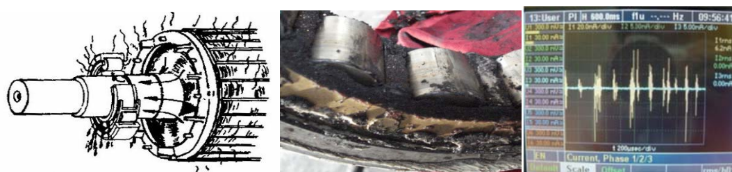
图 5-5 转子发热传导至轴承粉尘进入轴承轴电流流过轴承时的波形
